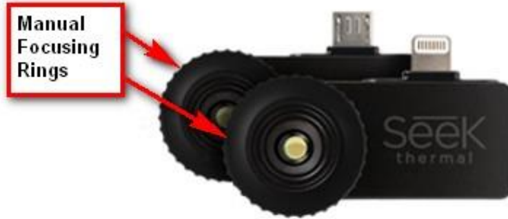
Resim 19: Compact Kamera Fokus Mekanizması
